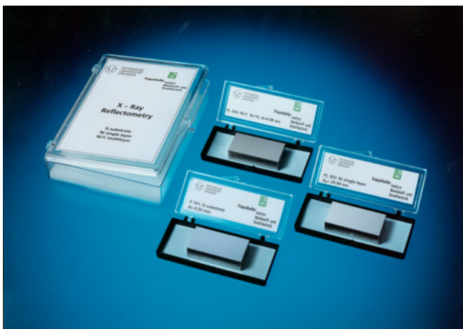
Lehrmittelsatz für die Röntgenreflektometrie: Silliziumsubstrat, Ni -Einzelschicht, Ni/C-Vielfachschicht (10 Perioden)
